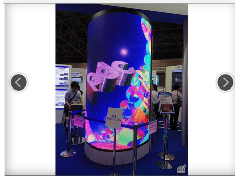
会場内でも特に目立っていたのが、PDCの円柱型LEDディスプレイ「FOREST VISION-FLEX」。シリコンゴムを使用した薄型軽量パネルのため、丸い柱など曲面への設置ができるという。マグネットによる取り付けのため、簡単に施工ができ、メンテナンス性も重視している。
