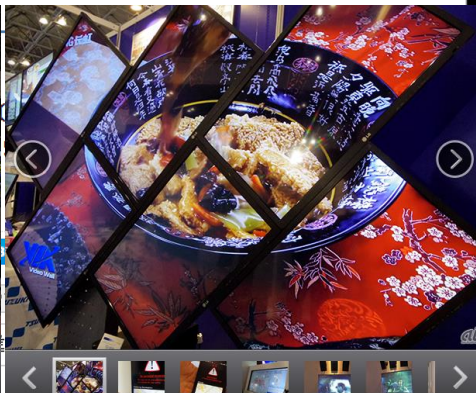
都築テクノサービスでは、自由な形にモニターを組み合わせて1つの映像を映し出すことができる「トランスフォーム・ディスプレイ」を展示。写真は6枚のディスプレイを斜めにレイアウトした状態だが、最大84台までのモニターを接続できるとのこと。目をひきつけるレイアウトにすることで、注目を集められるという。
